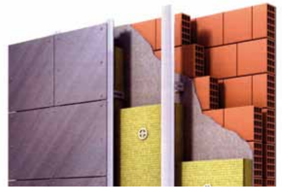
Sopra: esempio di sezione verticale tipo di facciata ventilata con rivestimento leggero (lastra composta sottile in lana di roccia ad alta densità). (Documentazione tecnica Rockwool Italia)
